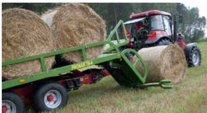
Простая система размещения рулонов на платформе
