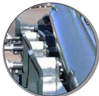
Рама шасси высокой прочности с роликами несущими контейнер
