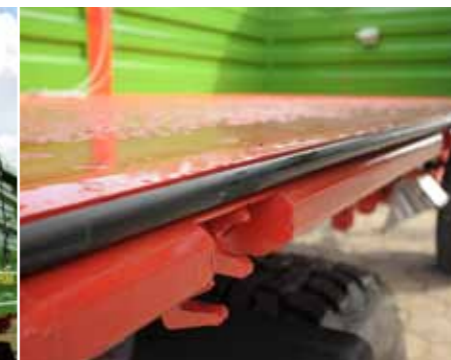
Сменные резиновые прокладки, обеспечивают герметичность кузова (T683U)
