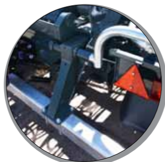
Гидравлически выдвжной задний бампер
