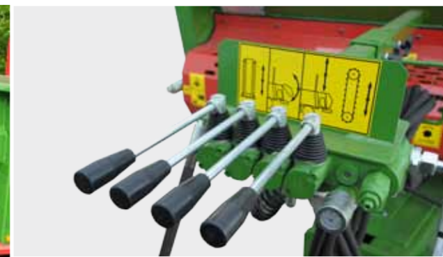
Разбрасыватель PRONAR N262/1 - гидравлический привод конвейера
