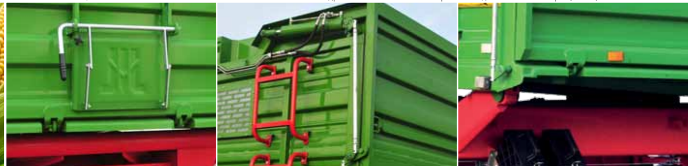
Сыпной люк для зерна с задвижкой.
