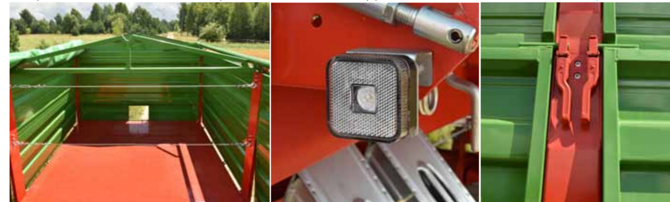
Грузовая платформа предназначена для перевозки европоддонов, с центральными стойками защищенными с помощью тросов
