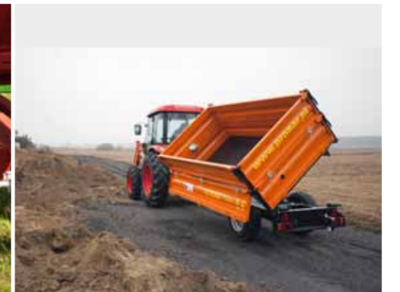
Система трехсторонней разгрузки с задними шаровыми шарнирами с оптимальным расстоянием
