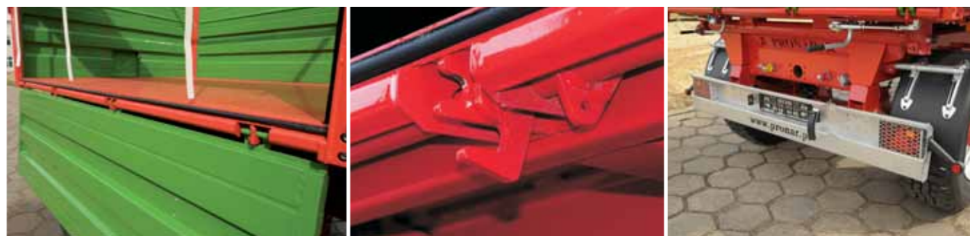
Сменные резиновые прокладки размещенные на краю пола, обеспечивающие абсолютную герметичность кузова (T680U)
