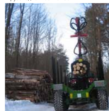
Поворотный кран-манипулятор грузоподъемностью 450кг
