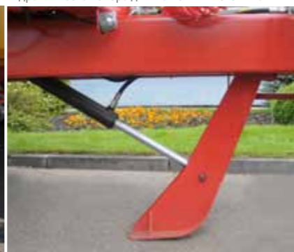
Гидравлическая опора дышла ножничного типа
