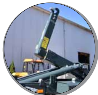
Подъем осуществляется двумя гидравлическими цилиндрами
