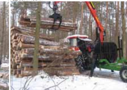
Опоры крана-манипулятора выдвигаются гидравлически
