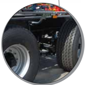
Подвеска с задней поворотной осью управляемой пассивно
