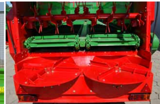
Разбрасыватель PRONAR N262/1 - Адаптер AH20 с двумя широко разбрасывающими тарелками
