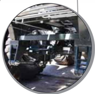
Подвеска тандем на параболических рессорах
