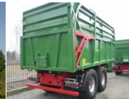
Гидравлическая система подъема заднего борта
