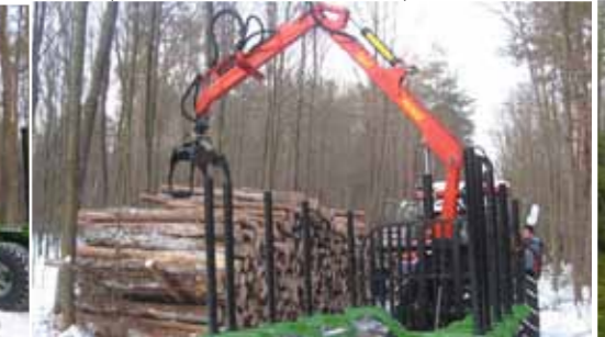
Задняя рама со стойками выдвигается гидравлически
