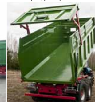
Система разгрузки с углом 50°
