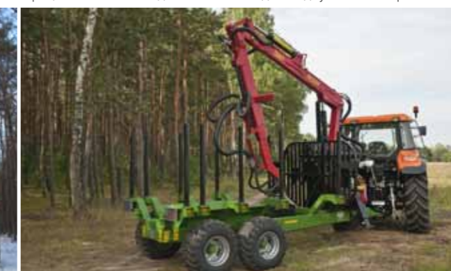
Прицеп-лесовоз на подвеске типа «тандем» с двумя балансирами
