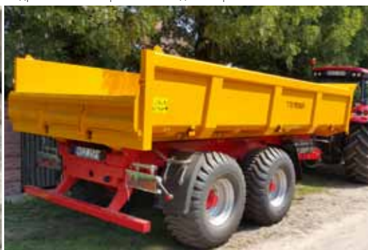
Гидравлически открываемый задний борт.
