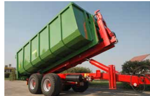
Работа в режиме опрокидывания и загрузки контейнера
