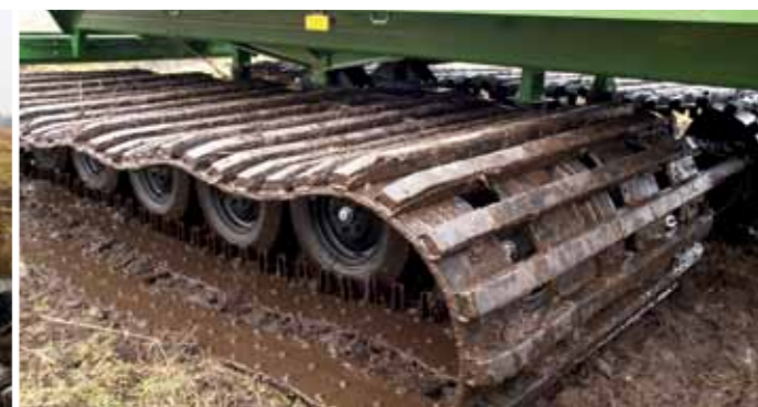
Гусеницы со сменными резиновыми накладками.
