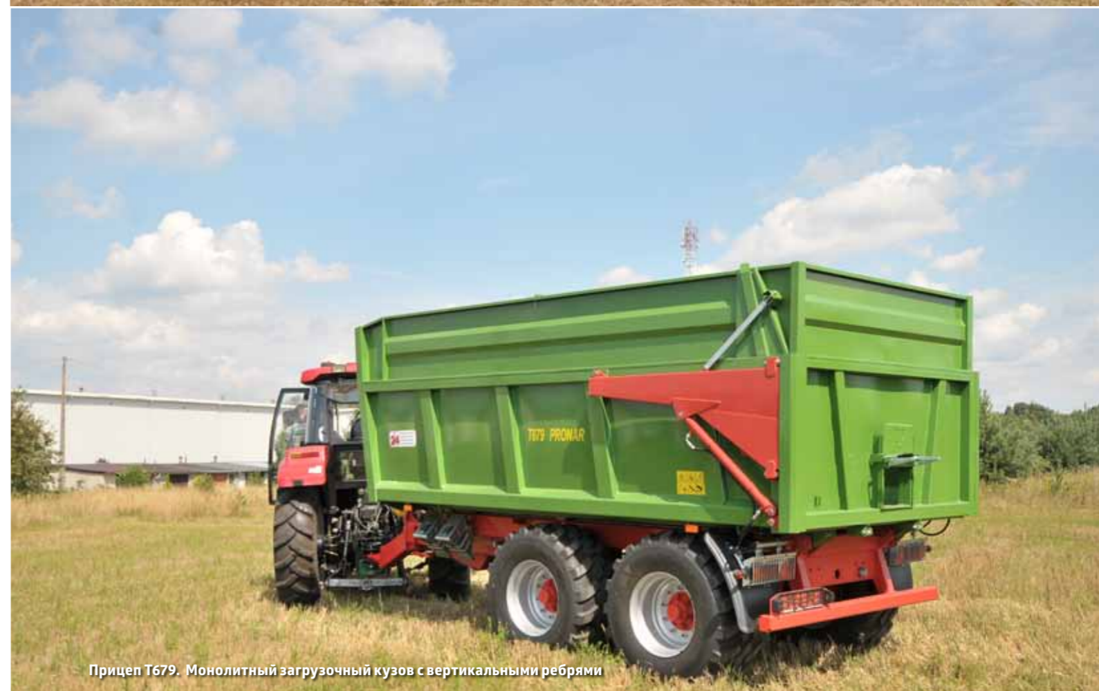
Монолитный кузов с профилированными боковыми бортами с укрепленным краем верхнего борта (T679M)
