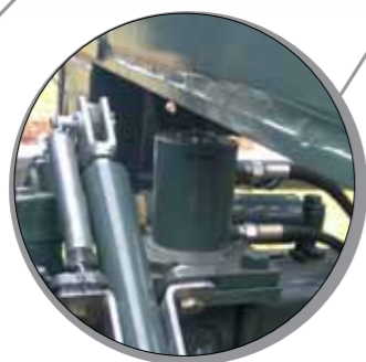
Гидравлическая блокировка подвески
