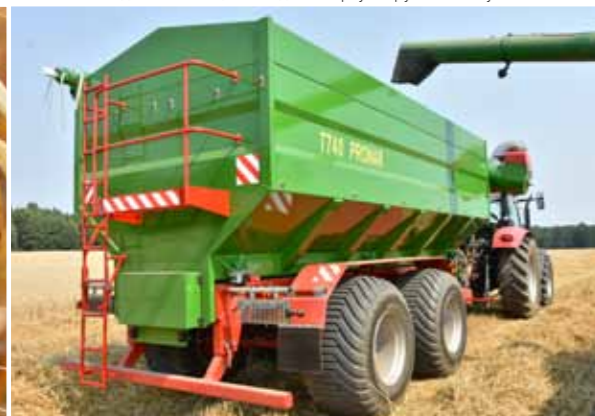
Балкон и складная лестница на заднем борту загрузочного кузова
