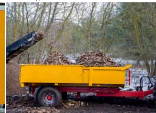
Задний борт высотой 325 мм, открываемый гидравлическим способом, открывается вниз T679/5 - загрузка
