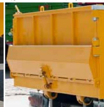
Задний борт высотой 325 мм, открываемый гидравлическим способом, открывается вниз T679/5 - загрузка
