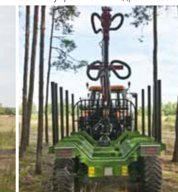
Мощная несущая рама с поперечными боками управляемая гидравлически
