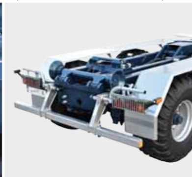
Гидравлически выдвигающийся задний бампер
