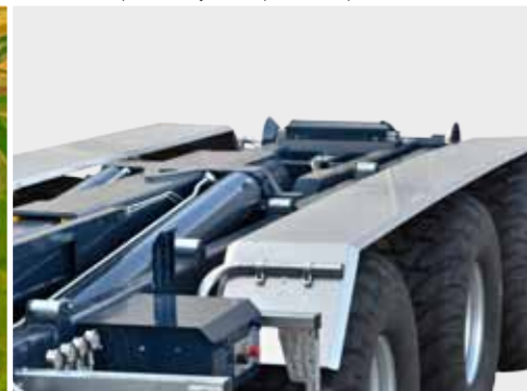
Стабильная рама с двумя гидроцилиндрами
