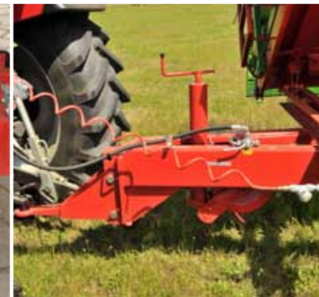
Неподвижное дышло для соединения с нижним прицепным устройством трактора
