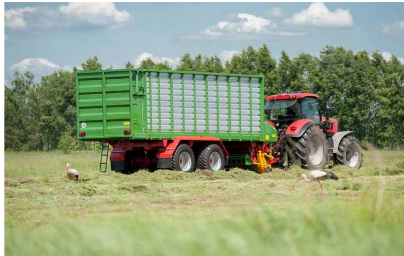
Подборщик кулачковый с восемью рядами подбирающих пальцев с роликом и копирующими поворотными колесами
