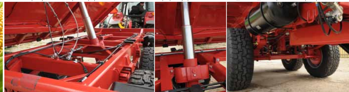
Рама шасси прямоугольная из закрытых профилей
