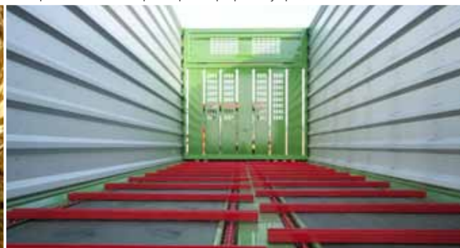
Четырехцепной конвейерный транспортер в полу прицепа
