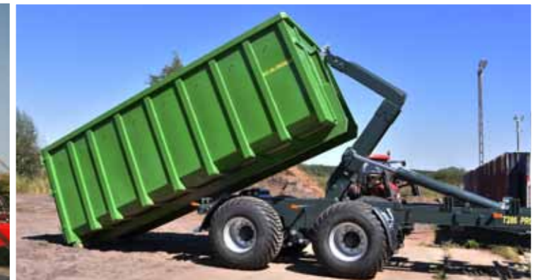
Работа в режиме опрокидывания и загрузки контейнера
