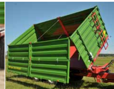
Грузовая платформа с универсальной системой открытия бортов с задними и центральными стойками (T683, T683U)
