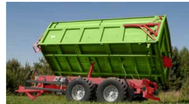
Прицеп T669/1 с правосторонней разгрузкой с углом 45°
