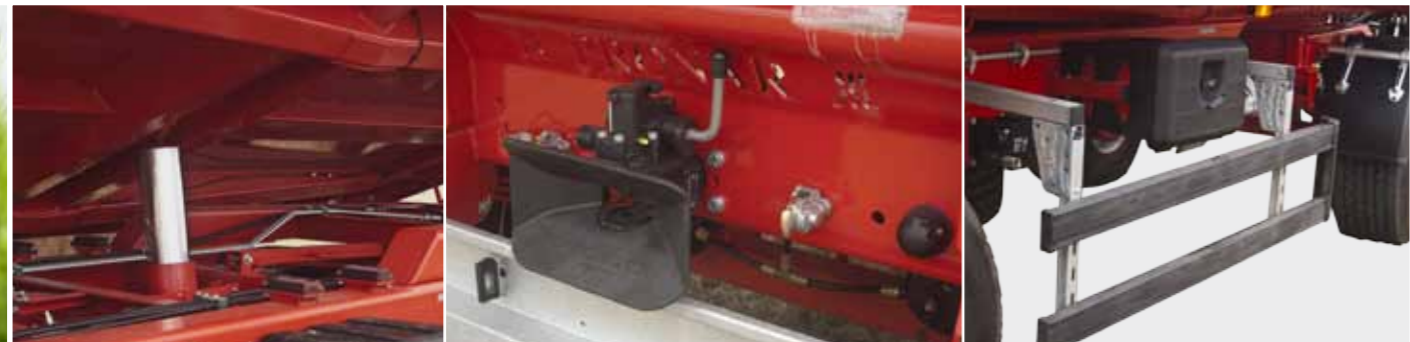
Телескопический цилиндр трехсторонней разгрузки с шарнирной конструкцией
