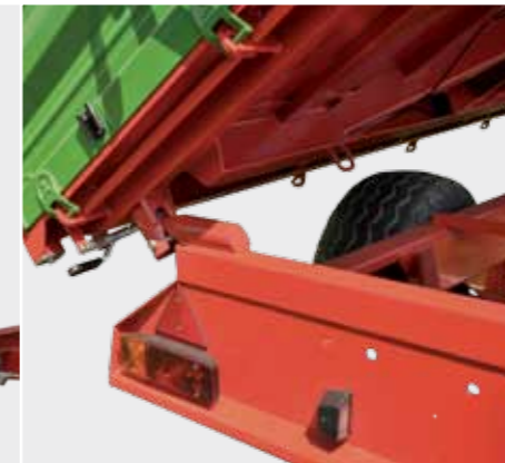
Система разгрузки с шаровыми шарнирами сзади
