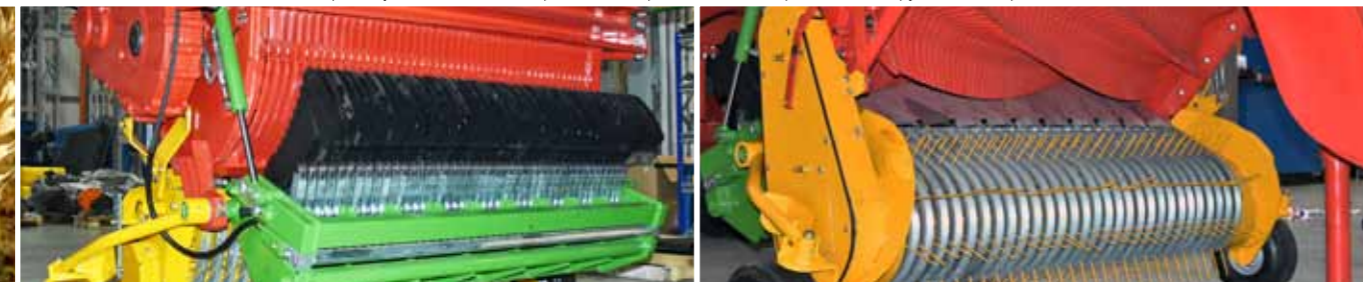
Подборщик кулачковый с восемью рядами подбирающих пальцев с роликом и копирующими поворотными колесами
